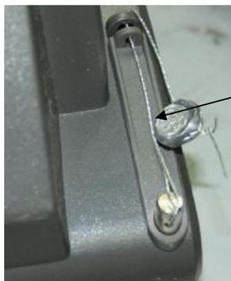
Пломбировка свинцовой пломбой корпуса КХ-3190-А12Е препятствующая доступу к переключателю режима настройки на печатной плате внутри прибора
