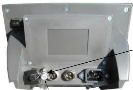
Пломбировка свинцовой пломбой доступа к переключателю режима настройки на задней панели корпуса приборов SKI-12
